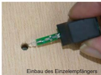
Einbau des Einzelempfängers
