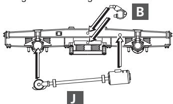
(DE) Drehgestell ohne Lichtmaschine mit Achslagerdeckel
