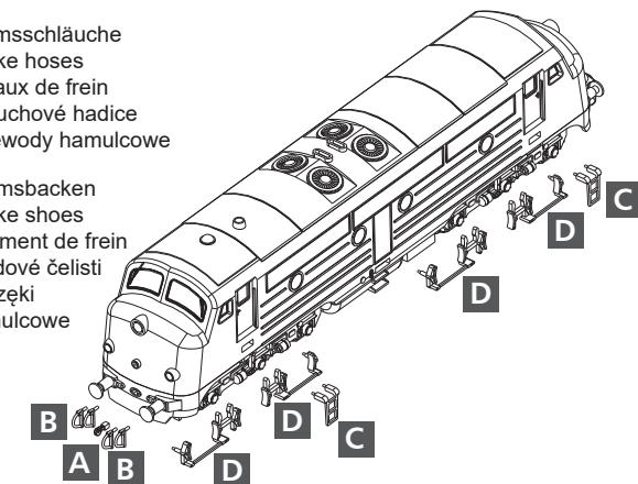
(DE) Montierte Bremsschläuche beeinträchtigen die Funktion der Kupplungsdeichsel.
