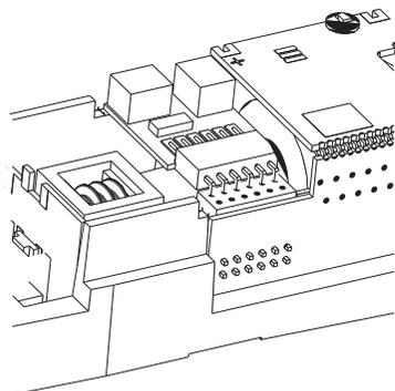
**(DE)** Für eine Digitalisierung gibt es im Modell eine PluX12-Schnittstelle. Wir empfehlen die Verwendung eines Decoders PluX12 von Uhlenbrock (TILLIG Art.-Nr. 66035). Zum Einbau des Decoders ist das Oberteil entsprechend der Anleitung auf Seite 1 abzunehmen. Quer in der Rahmenaussparung befindet sich die Decoderschnittstelle.
