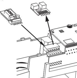
**(DE)** Zum Einbau eines Decoders nach NEM 651 S klein wird nur der Entstörsatz abgezogen. Danach kann ein Decoder nach NEM 651 S klein eingesteckt werden. Hierfür empfehlen wir den Decoder von Uhlenbrock (TILLIG Art.-Nr. 66032).
