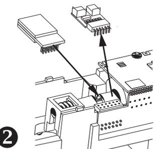
**(DE)** Zum Einbau eines PluX12-Decoders nach NEM 658 wird der Entstörsatz mit dem Adapterleiterplatte abgezogen. Danach kann ein PluX12-Decoder eingesteckt werden.
